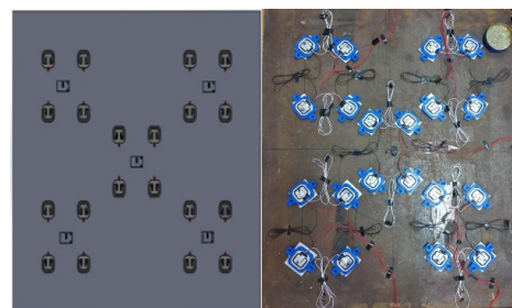
Gbr. 2 Letak Load Cell pada plat baja.
